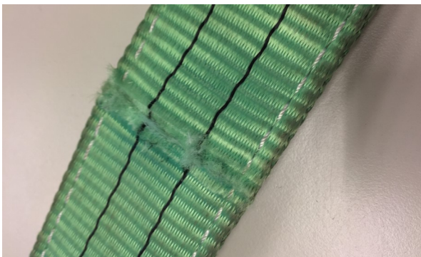
Bild 4-1: Unzulässiger Einschnitt an der Oberfläche
