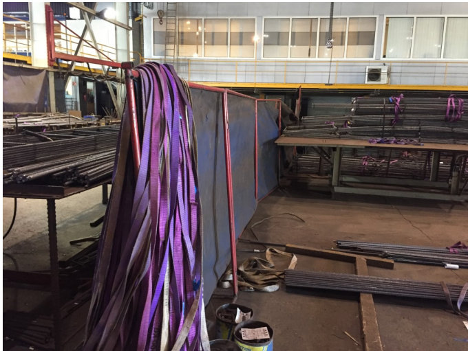
Bild 5-1: Günstige Lagerung von Anschlagmitteln, Beispiel 1
