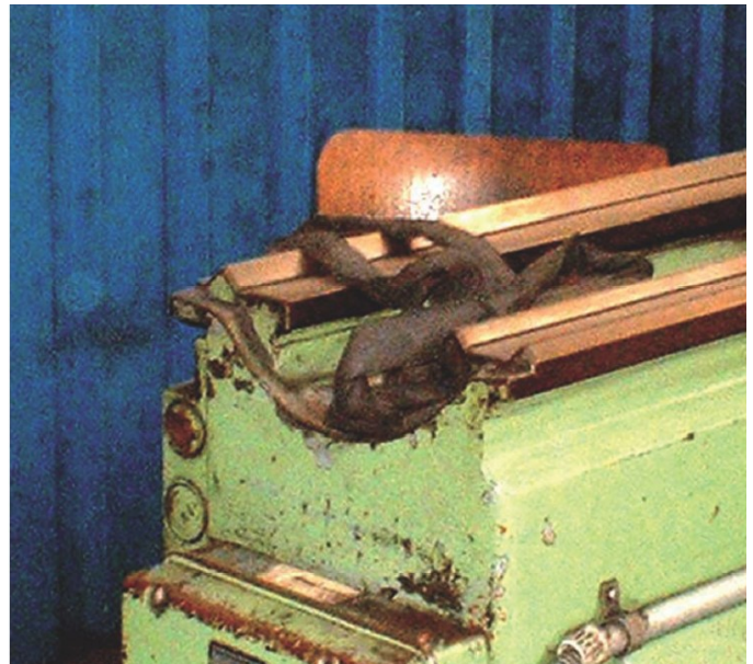
Bild 5-2: Ungünstige Lagerung von Anschlagmitteln, Beispiel 2
