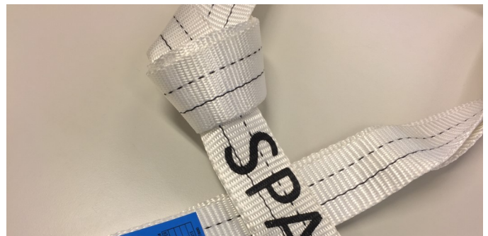
Bild 1-3: Unzulässiger Knoten in einer Schlinge
